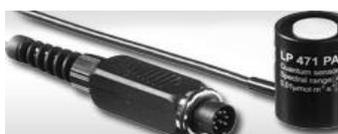
**LP471 UVA** Sonda radiometrica per la misura dell'IRRADIAMENTO nel campo spettrale UVA 315 nm ... 400 nm, picco a 360 nm, diffusore per la correzione del coseno in quarzo.
