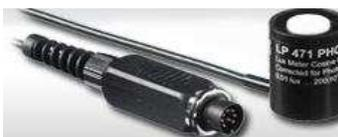
**LP471 RAD** Sonda radiometrica per la misura dell'IRRADIAMENTO nel campo spettrale 400 nm ... 1050 nm, diffusore per la correzione del coseno. Range: 0,1 mW/m<sup>2</sup> ... 2000 W/m<sup>2</sup>.
