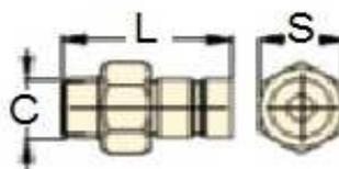
Giunti rapidi per oleodinamica, portata 12 l/min, pressione di lavoro 350 bar.
