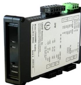
4-20 mA, 0-20 mA, 0-10 V o -10V a + 10V trasmettitore analogico, isolato, jumper selezionabili dall'utente e scalabile. Tutte le selezioni forniscono un 16 bit (0,0015%) di risoluzione del campo di uscita e 0,02% di precisione. Isolamento dell'uscita e dell'alimentazione per eliminare potenziali loop di massa.
