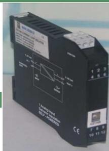
**Canale 1 - INGRESSO PASSIVO:** collegamento da utilizzare con trasduttori in tecnica a 2 fili. Il trasduttore alimenta il modulo con una corrente compresa fra i 4 e i 20 mA. Caduta di tensione a 20 mA: 7V per  $RL < 160\Omega$ ;  $RL \cdot 0,02 + 3,8$  per  $RL > 160\Omega$
