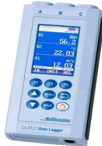
Funzioni HOLD (congela le misure correnti a display), REL (differenza rispetto a un valore memorizzato) e DIFF (differenza tra due misure omogenee, per esempio tra le misure di due sonde di temperatura).
