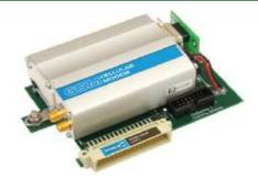
Interfaccia Network: telefonia mobile per accedere a Internet tramite le reti GSM
