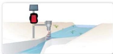
Canali molto grandi sono stati solitamente misurati usando canaline e stramazzi usando calcoli empirici. Normalmente questo calcolo è basato sulla misura della profondità dell'acqua fluente attraverso il primario di misura. Oggi questo metodo è superato dall'uso di più moderni sensori ad immersione area/velocità più economici e facili da installare. HM3000 incorpora l'equazioni di calcolo dei principali primari quali:
