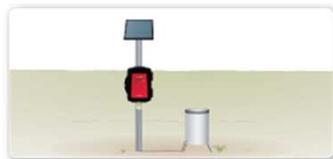
HM3000 è un sistema autonomo a batteria solare che consente la registrazione di dati ambientali anche in zone isolate e non raggiungibili da allacciamenti elettrici e linee telefoniche cablate. E' così possibile il controllo pluviometrico locale in ambiente e la trasmissione dei dati centralizzata nel punto di raccolta proveniente da diverse centraline.
