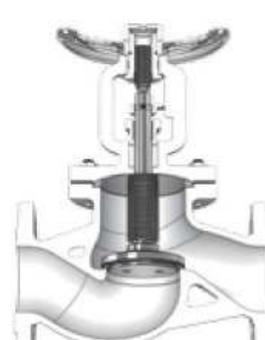
Otturatore a tenuta morbida di PTFE intercambiabile
